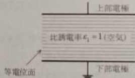
図 2 空気中平行平板電極の断面図
